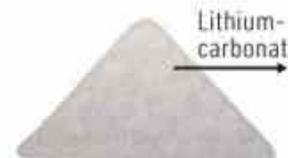
Aus der verbleibenden Schlacke wird Lithiumcarbonat mit Hilfe eines hydrometallurgischen Verfahrens gewonnen.
